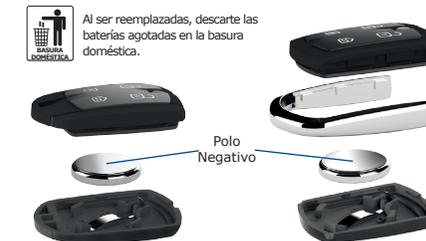
Para cambiarla, abra el control remoto descajando las tapas con cuidado. Retire la batería. Coloque la nueva batería en el control remoto teniendo cuidado de no invertir la polaridad. Utilice baterías CR2032 (3V).
