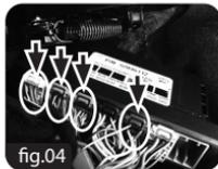
gris, pin 21 del conector blanco de 26 vías en la central electrónica, fig. 04;
